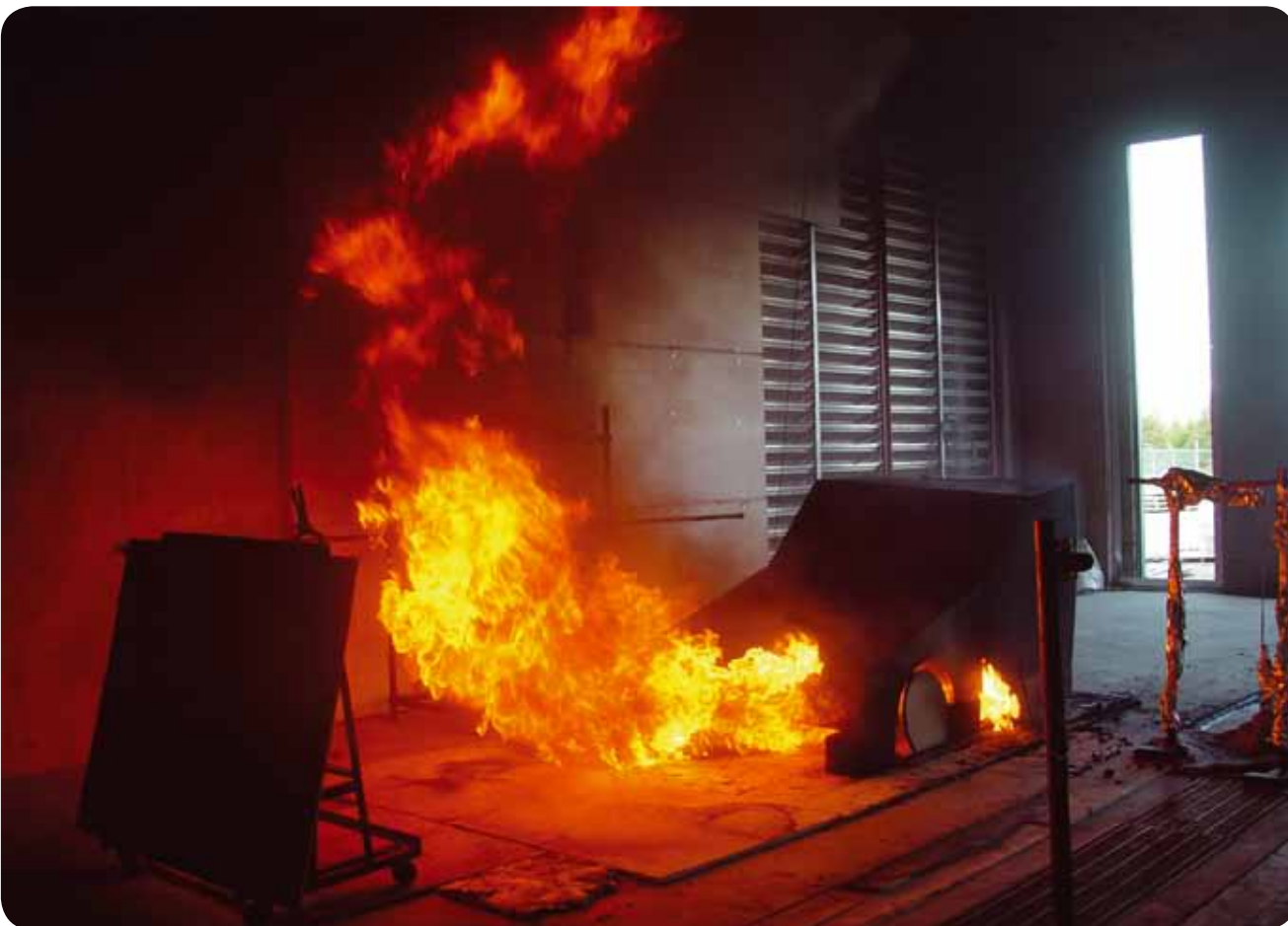
Figure 6 - Photographie d'une nappe incendiée sous un véhicule dans le tunnel-laboratoire
