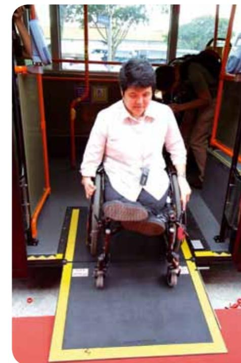
Figure 2 - Bus à plancher surbaissé accessible aux fauteuils roulants
