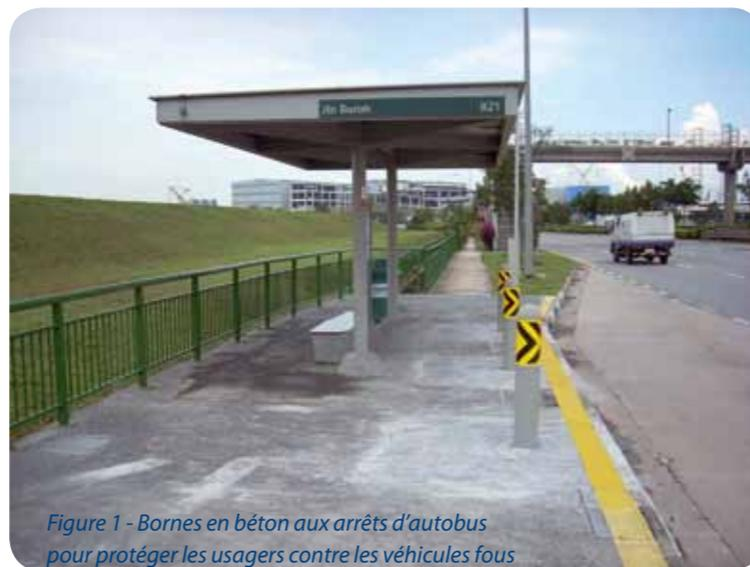
Figure 1 - Bornes en béton aux arrêts d'autobus pour protéger les usagers contre les véhicules fous
